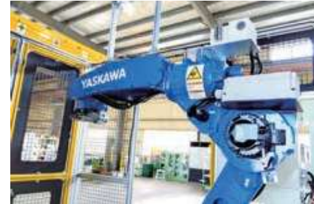
産業用ロボットを用いたハンドリング設備
