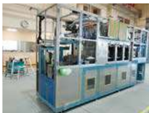
ピッチ送りコンベヤ式シャワー洗浄装置
