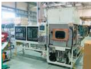
バッチ式洗浄装置 (投入コンベヤ付き)
