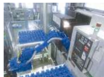
加工機投入ハンドリング装置
