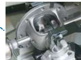
球面加工(左右) 球面と内面取りを加工
