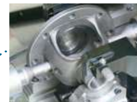
シャフト穴加工(左右) 下穴・中仕上・入口面取りの同時加工 高速リーマにより超高速仕上げ加工
