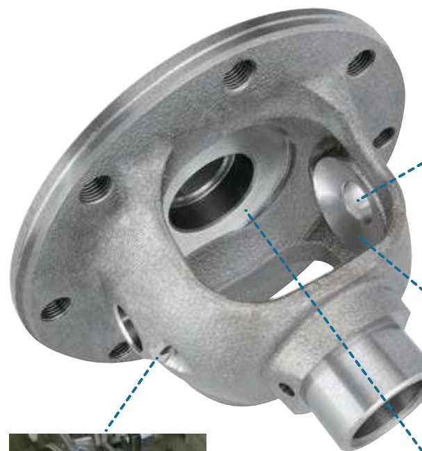
シャフト穴加工(左右) 下穴・中仕上・入口面取りの同時加工 高速リーマにより超高速仕上げ加工
